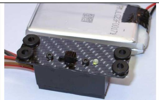
Lithium-Polymer (LiPo) Akkus haben entscheidende Vorteile bei Kapazität und Ladetechnik. Wegen ihrer Spannung können sie aber nicht direkt an Modellbauempfänger angeschlossen werden. Dieses Komplettsystem enthält alles was man braucht um die neuen LiPo AKkus als Stromversorgung für Empfänger, Servos und Zusatzgeräten einsetzen zu können.
