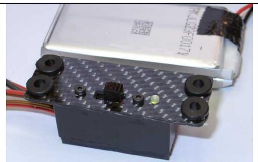
**Eine Besonderheit von VS-5S und VS-5P ist, dass eine große Funktionsvielfalt auf kleinstem Raum realisiert werden konnte. Durch die Integration eines vollwertigen FET Schalters und Akkumonitors erübrigen sich weitere Zusatzgeräte. Dadurch ist nicht nur der Gesamtpreis niedrig, sondern vor allem das Gewicht minimal was zusammen mit den leichten LiPo Zellen große Vorteile für die Flugeigenschaften bietet.**
